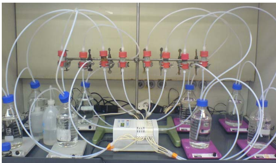
Abb. 36: Versuchsaufbau mit 8 Differentialkreislaufreaktoren
