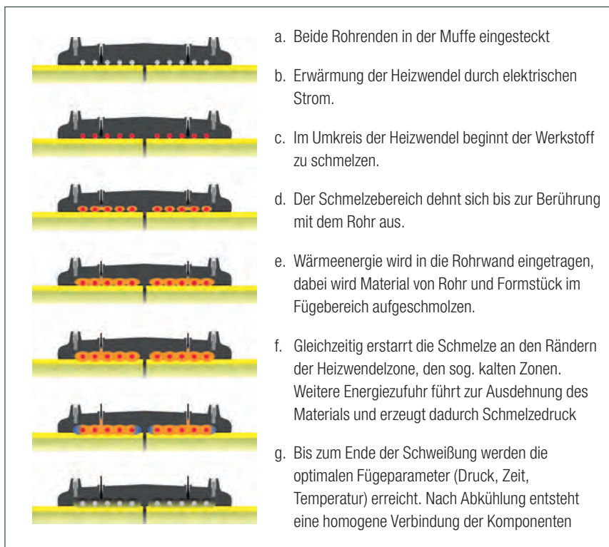
Abb. 8: Prozessbeschreibung einer Heizwendelschweißung am Beispiel einer Muffenverbindung
