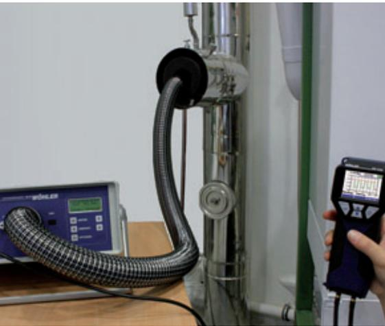
Abb. 3: Geregeltes Absaugsystem bei Anwendung des „ausführlichen Messverfahren“
