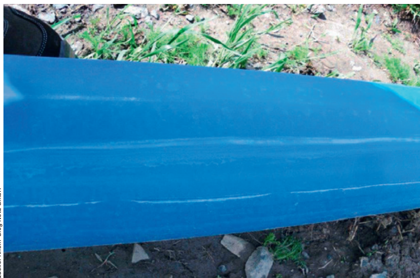
Abb. 1: Beschädigtes PE-Rohr auf der Baustelle
