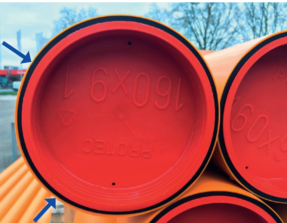
Abb. 3: Coex-Rohr – Unterschiedliche Stärke der farbigen Kennzeichnungsschicht um den Rohrumfang
