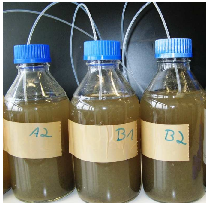
Abbildung 22: Batchansätze in Anlehnung an den Zahn-Wellens-Test zur Untersuchung der Auswirkungen von Nitrifikationshemmern auf den Abbau anderer organischer Spurenstoffe.
