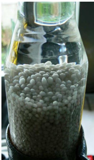
Abbildung 19: Zylinder mit Sinterglasperlen (links) und schematischer Aufbau des Festbettbioreaktors (rechts).
