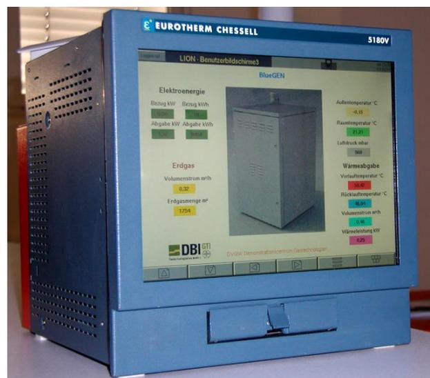
Abbildung 136: Datalogger mit gerätespezifischem Benutzerbildschirm
