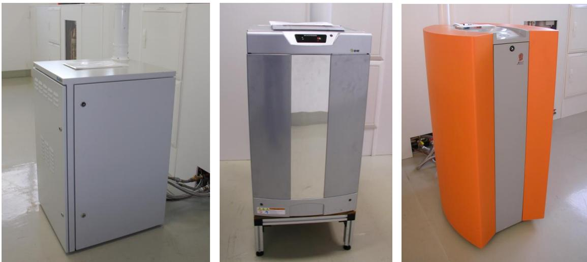
**Abbildung 137:** Dauertest von Mikro-KWK-Geräten im Demonstrationszentrum am DBI
