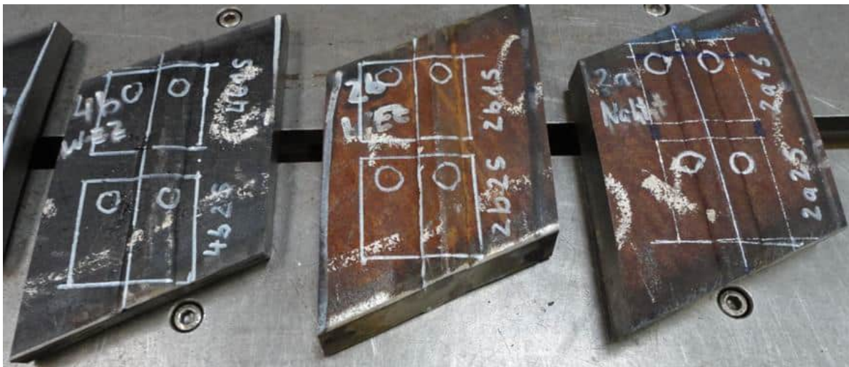
Abbildung 2.3: Probenentnahme aus einem Rohr mit einer Spiralnaht
