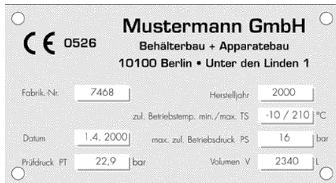
Abb. 5.6 Beispielhafte Darstellung des Typenschildes eines Druckgeräts mit CE-Kennzeichnung und Kennnummer der notifizierte Stelle links oben /DGO 20/
