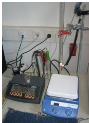
Abbildung 4-8: Messplatz für FOS/TAC-Bestimmung
