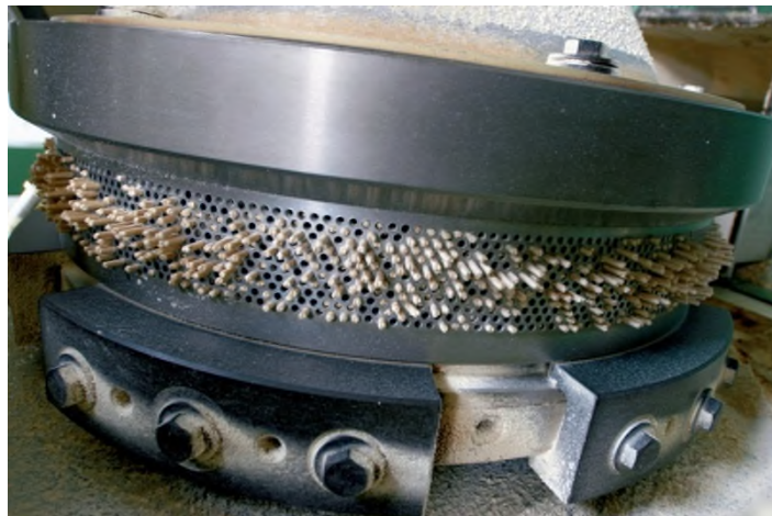
Abbildung 5-32: Pellets aus Ringmatrize[177]
