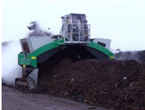
Abbildung 5-28: Maschinelle Belüftung und Umschichtung [172]
