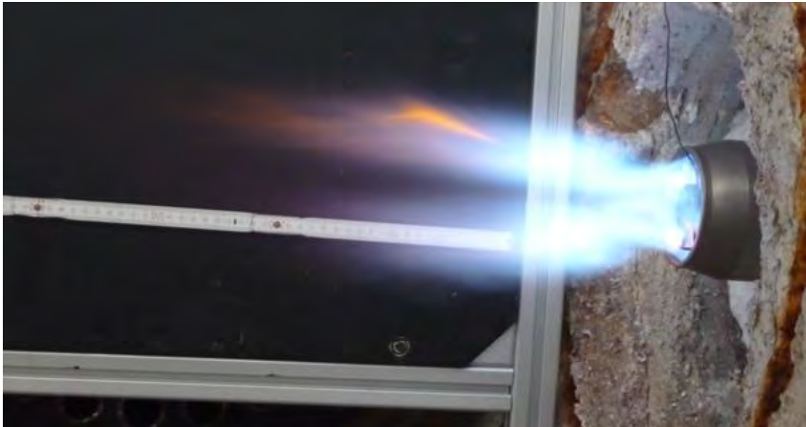
Abbildung 4-96: Abschätzung der Flammenlänge im Freibrand (H-Gas Ref._DBI)
