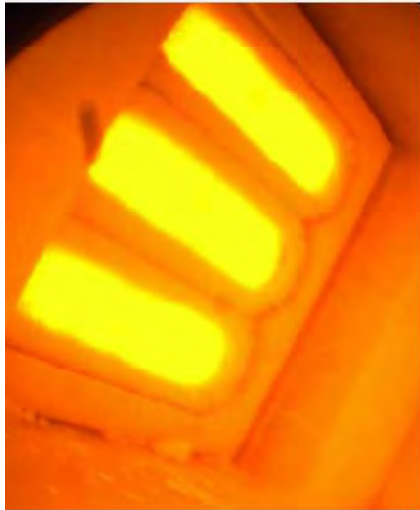
Abbildung 4-3: Brennertechnik (Keramische Strahlungsbrenner) in der Glas- und Keramikindustrie auf Basis von Erdgas [4.4]
