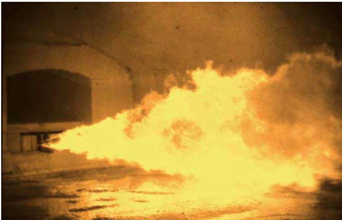
Abbildung 4-2: Diffusionsflammen Freistrahlebrenner mit direktem Kontakt [4.4] auf Basis von Erdgas
