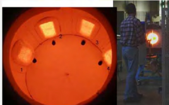
Abbildung 4-3: Brennertechnik (Keramische Strahlungsbrenner) in der Glas- und Keramikindustrie auf Basis von Erdgas [4.4]
