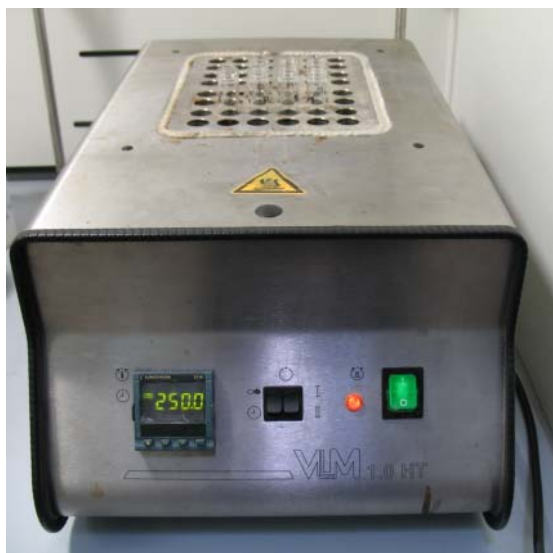
Abb. II.1. 96: Heizblock zur Untersuchung der Temperaturstabilität; die ILs wurden jeweils 1 h bei 150, 200, 250 und 300 °C erhitzt
