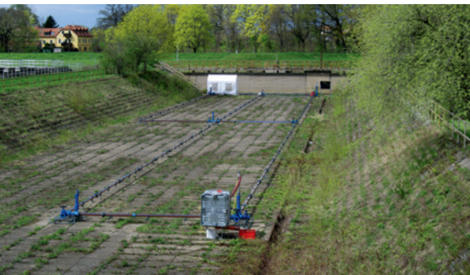
Abb. 1: Modellnetz des TZW DN 100 aus PVC-klar-Rohren
